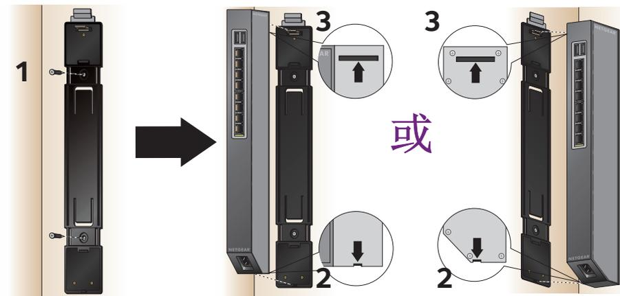
注意: 在墙壁上安装交换机时, 必须用螺丝将背板固定到墙体上。
