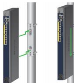
将交换机接到圆柱上
