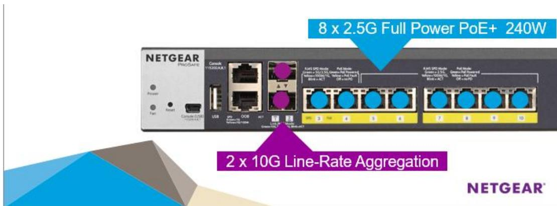
NETGEAR M4200 交换机，是 NETGEAR 最新发布的多千兆交换机，8 个 2.5G 端口，每一个端口都支持 PoE+供电，并且，这 8 个端口的其中 2 个还可以支持 5Gbps，另外，还有 2 个 10Gbps SFP+上联口。可以完美支持 8 台 Wave 2 11ac AP 的部署，无论是上联速率（ $8 \times 2.5\text{Gbps} = 20\text{Gbps}$ ），还是 PoE+供电预算（ $30\text{W} \times 8 \text{ 端口} = 240\text{W PoE}$  预算），都能 100%满足需求。
