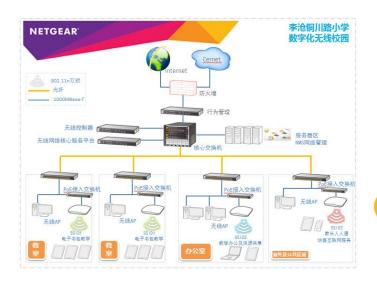
无线网络建设项目需求为实现校园区域全无线覆 盖,并支持电子书包解决方案。无线 AP 通过 8 台 24 端口全 POE+ 802.3 at 供电交换机 GSM7224P 进行 统一集中网线供电。NETGEAR 第三代智能无线控制 器 WC9500 连接核心交换机,实现无线 AP 统一管理 及数据流高速本地转发。整体网络采用 UCNS-1500 讲行准入控制,只有合法终端才可以接入网络。
