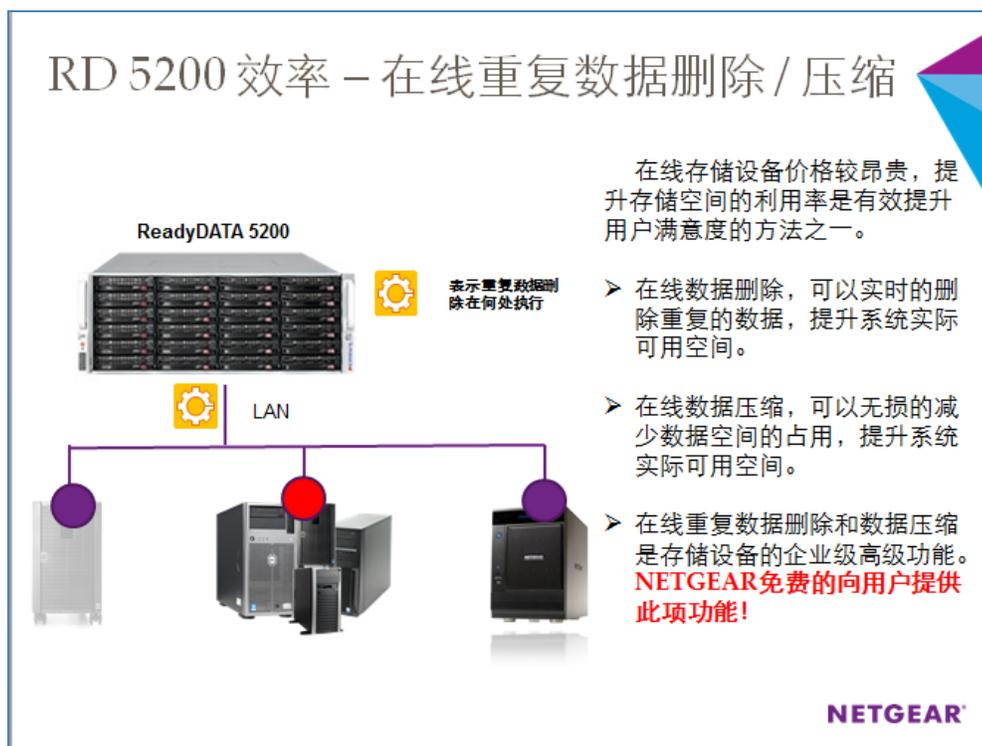
在线数据压缩是指在不丢失信息的前提下, 按照一定的算法对数据进行重新组织, 缩减数据量以减少存储空间, 提高其传输、存储和处理效率的一种技术方法。当将数据备份入 ReadyDATA 5200 时, ReadyDATA 5200 将执行一系列压缩算法, 对数据进行压缩存储, 进一步节省存储空间, 并且不影响性能。相对于传统存储厂商“离线”式数据压缩方案, Netgear ReadyDATA 的实时数据压缩方式不但可以有效的减少数据空间的占用率, 而且在多台 ReadyDATA 设备灾备期间, 由于数据压缩传输, 可以大大的减少数据传输的数量, 有效的提升了灾备系统的效率和实时性。
