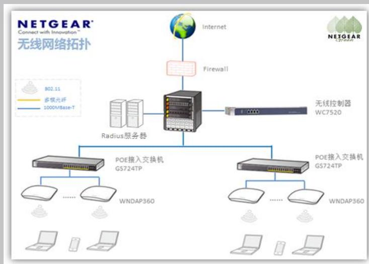
方案使用一台 NETGEAR 智能无线控制器 WC7520 和 28 台 802.11N 300M 四模双频无线接入点 WNDAP360 来为整个办公楼宇提供高速的智能无线网络信号覆盖。无线接入点 WNDAP360 均通过 24 个千兆端口 PoE 智能交换机 GS724TP 提供远程以太网网线（PoE）供电。
