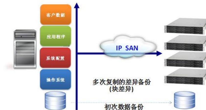
我们创新的裸机恢复解决方案以快速恢复业务生产为前提，完整保护系统及业务数据，在系统发生灾难时，依据独创的 iSCSI 远程启动技术，可以将系统及业务直接在 ReadyAS 存储设备上运行，然后可以在业务运行的情况下将 ReadyNAS 设备备份的系统及业务数据恢复到原业务主机上。
