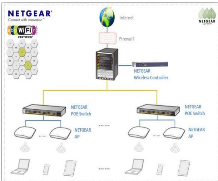
根无线网络建设项目需求为实现全区域无线覆盖。无线AP通过2台全24端口POE 802.3 af供电交换机GS724TP进行统一集中网线供电。NETGEAR第三代智能无线控制器WC7520通过千兆链路连接核心交换机，实现无线AP统一管理及数据流高速本地转发。
