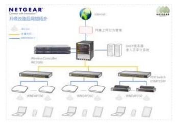
山东电力院现有管理楼、科技楼、历下楼三 座建筑物, 各建筑物之间使用千兆光纤连接。无 线网络建设项目实现所有办公区域全无线无缝覆 盖, 无线接入点采用 NETGEAR 高性能双频 AP WNDAP350/360,通过24端口全POE供电交换机 GSM7224P进行统一集中的网线供电。NETGEAR 万兆智能无线控制器WC9500连接核心交换机, 实现无线AP统一管理及数据流高速本地转发。
