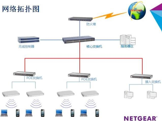
无线网络建设项目需求实现全区域无线覆盖，每层部署七台300M无线AP WNAP210。无线AP通过3台全24端口POE 802.3 af供电交换机GS724TP进行统一集中网线供电。NETGEAR第三代智能无线控制器WC7520通过千兆链路连接核心交换机，实现无线AP统一管理及数据流高速本地转发。
