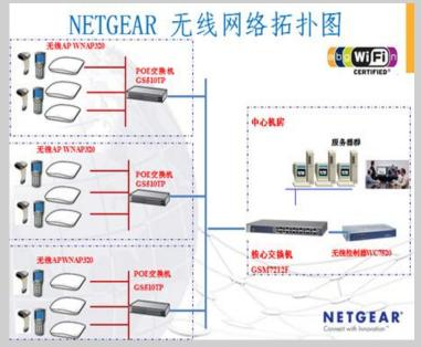
无线控制器使用NETGEAR智能无线控制器 WC7520, 可方便地对全网的无线AP进行集中管 理和统一配置。支持无线信道和功率动态控制、 无线用户负载均衡、众多的高级安全特性(如
