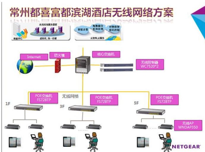
随着酒店内部系统应用的开展，无线网络的带宽有了更高的要求。基于用户需求的考虑，NETGEAR在此次无线方案中采用目前最为先进的分布式无线网络架构。在网络中心部署两台千兆智能无线控制器WC7520做堆叠，在1-2层公共区域放置802.11n双频FAT/FIT一体型无线接入点WNDAP350进行无线覆盖，3-6层在房间放置AP通过增加天线及馈线方式将外置天线引入每个房间，达到最佳信号覆盖效果。同时，通过百兆端口PoE智能交换机为AP提供集中的远程网线供电和数据转发。
