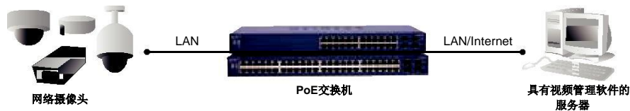
图 3: 基于网络摄像头的视频监控架构
